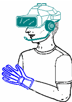
Figura 2 – Equipamento característico para a exploração de ambientes virtuais imersivos, como no projecto "Água Virtual". O capacete permite a visualização tridimensional e imersiva, enquanto a luva permite a interacção e manipulação de modelos do ambiente.
