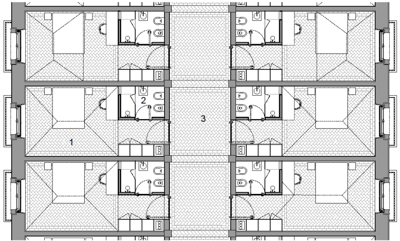
PLANTA PARCIAL DA COMPONENTE RESIDENCIAL PROJETO: ESCALA 1/20 1- UNIDADE HABITACIONAL 2- QUARTO DE BANHO 3- ESPAÇO DE CIRCULAÇÃO
