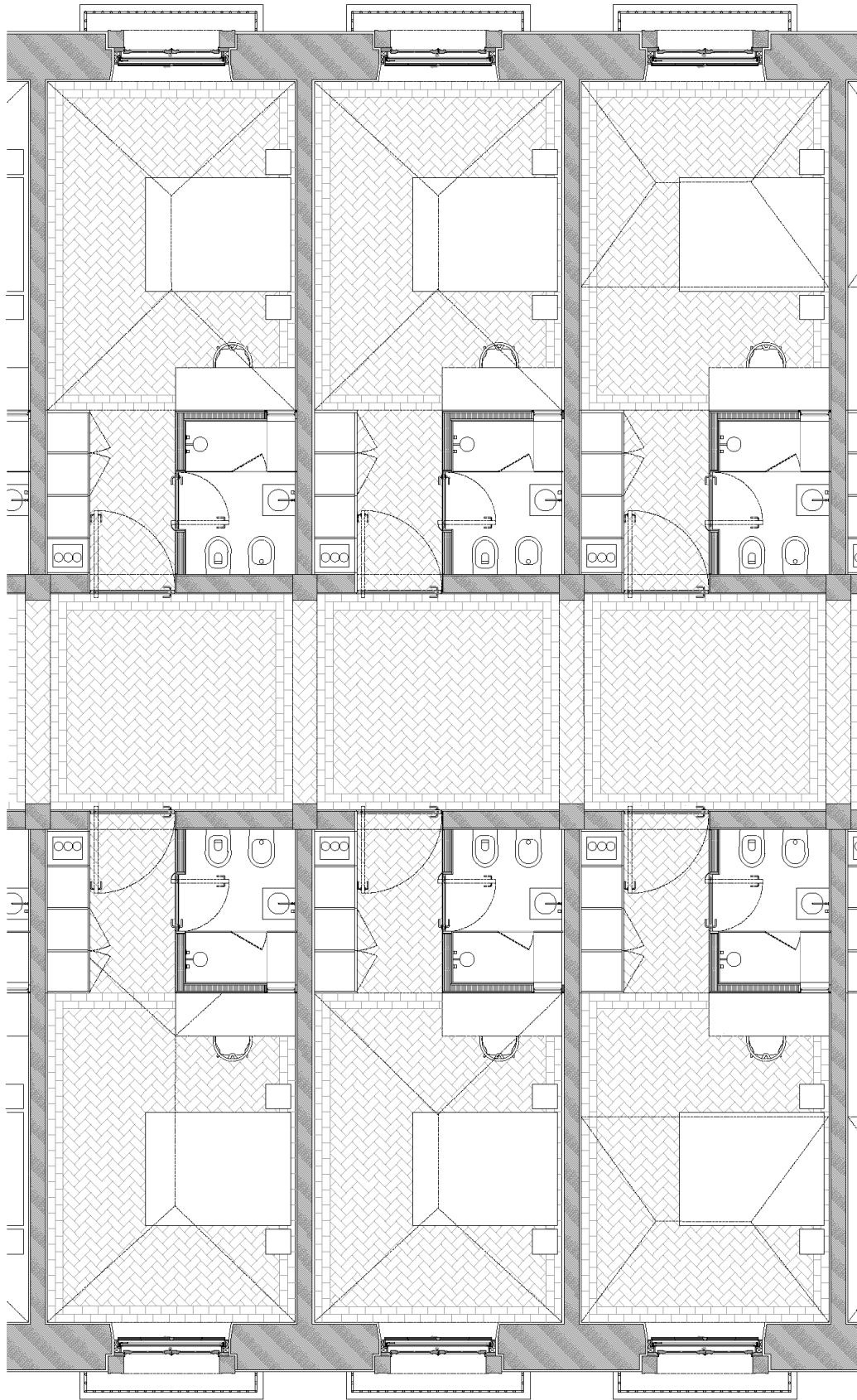
Figura 146 – Planta parcial da proposta na primeiro piso da componente residencial desenvolvida a escala 1:10.
