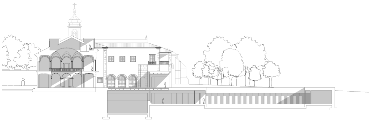
Figura 122 – Corte longitudinal do pátio proposto desenvolvido a escala 1:500
