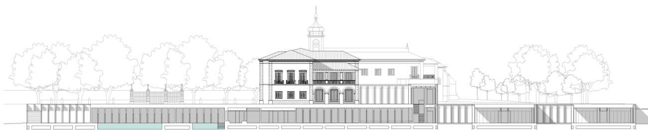
Figura 127 – Corte longitudinal ao rodapé que constrói o limite sul desenvolvido a escala 1:500
