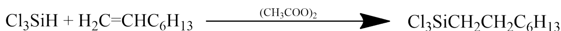
Esquema 1.9 – Reação de hidrossililação entre triclorosilano e 1-octeno na presença de peróxido de acetilo.
