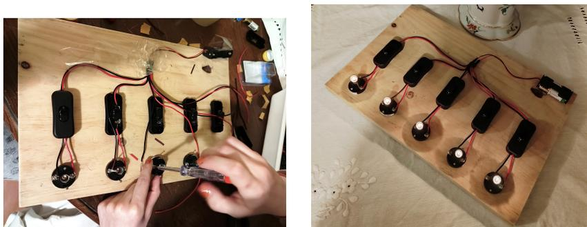
Fig. 5.2 Construção do circuito elétrico
