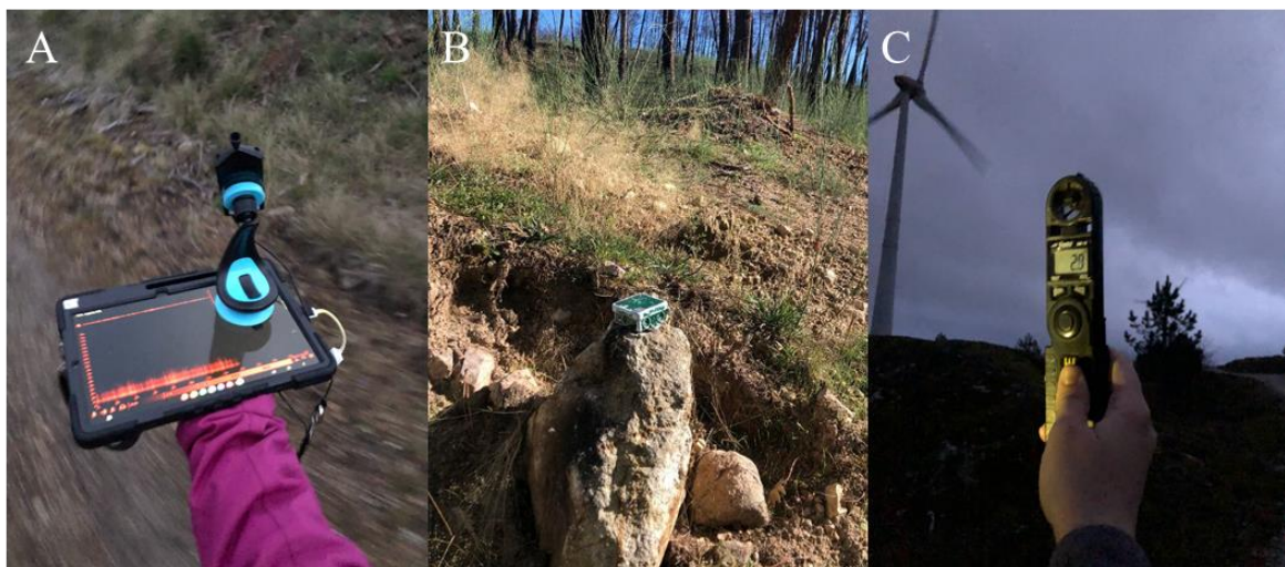
Figura 25 - Deteção acústica de quirópteros em saídas de campo. A - Transecto com utilização de microfone e a aplicação “Bat Recorder”; B - AudioMoth ; C - Medição da temperatura e do vento com anemómetro.
