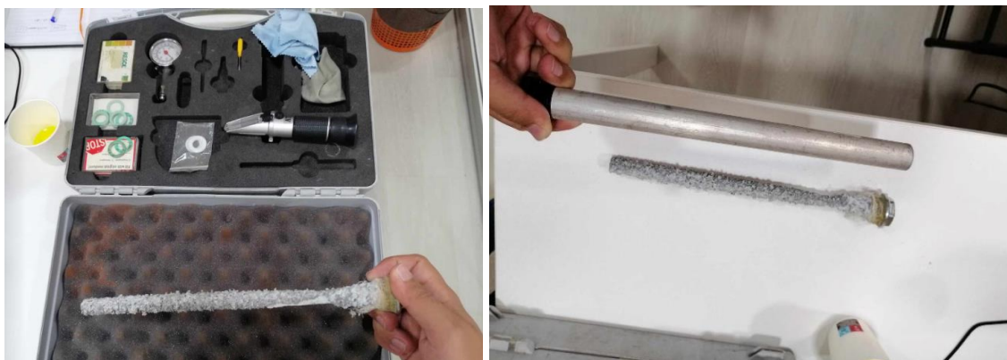
Figura 5.31. Ânodo corroído e ferramentas. Figura 5.32. Comparação de Ânodos de magnésio.
