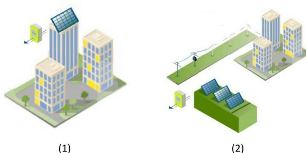
Figura 1 – Tipos de autoconsumo coletivo: (1) - Autoconsumo coletivo em rede interna, (2) - Autoconsumo coletivo com uso da rede elétrica de serviço público [7]
