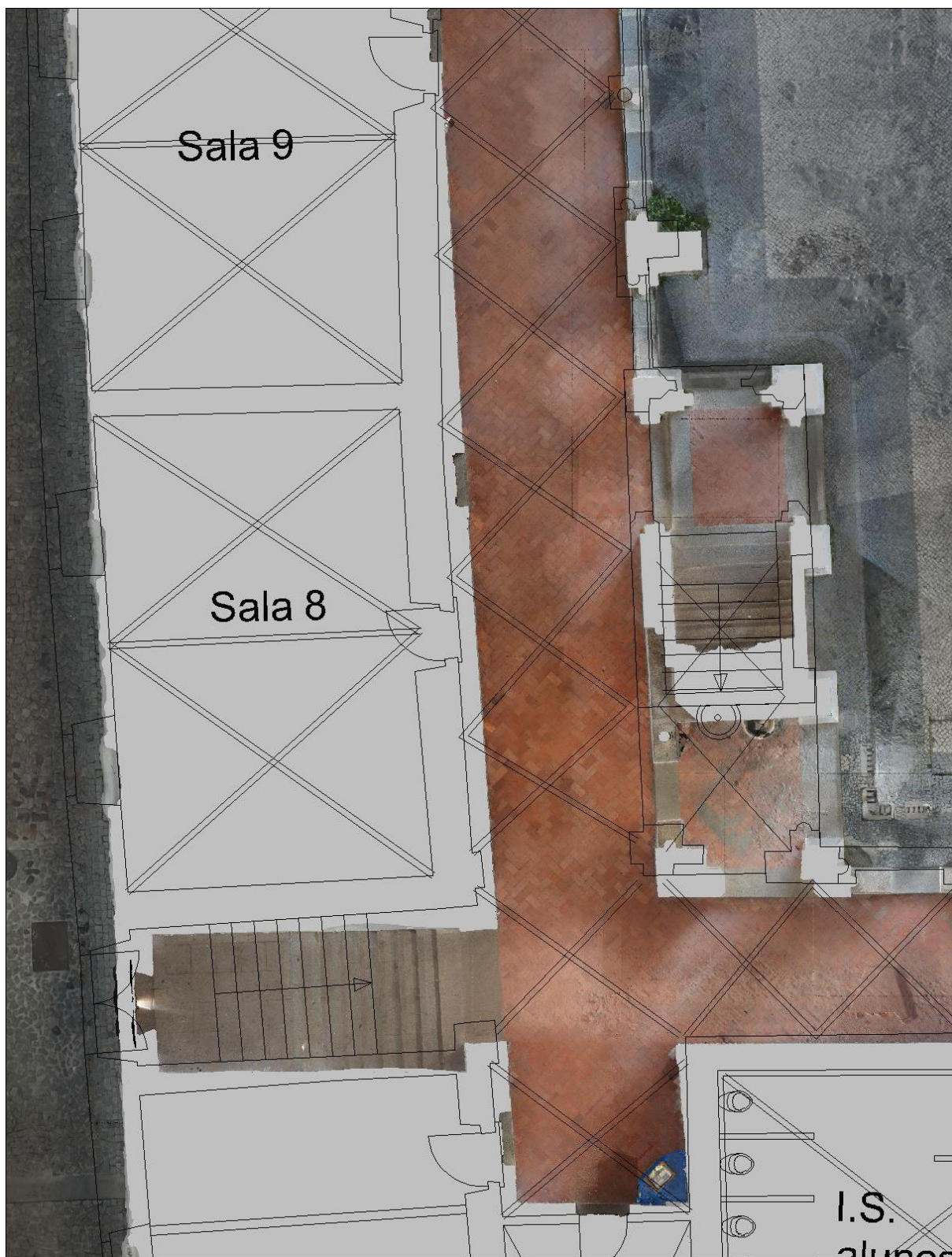
Pormenor à escala 1:100 da subposição da imagem (reduzida em 98,6%) ao desenho existente
