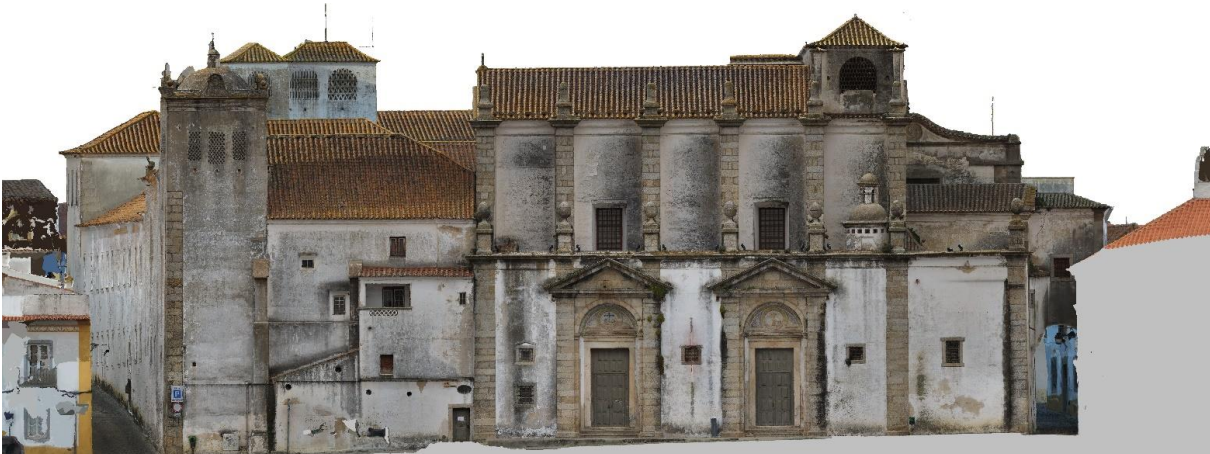
Ortoimagem – Corte pela Rua de Serpa Pinto, alinhamento pelo eixo da igreja
