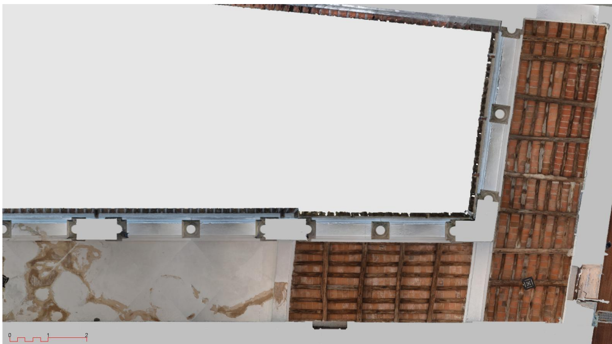
Fig. 6.2. – Planta parcial de tetos do piso superior do claustro do poço na Escola de Santa Clara, ilustrando diferentes materialidades e presença de patologias nas abóbadas. Esc. 1:100.
