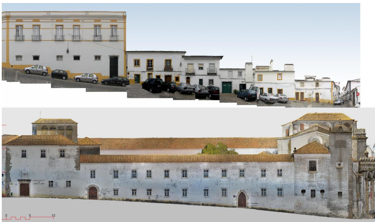
Fig. 6.1. Alçado SO do Largo Dr. Evaristo Cutileiro, obtido por retificação de imagens, em 2006 (fonte: CME); e alçado obtido agora, por fotogrametria, para a Rua de Santa Clara. Esc. 1/500
