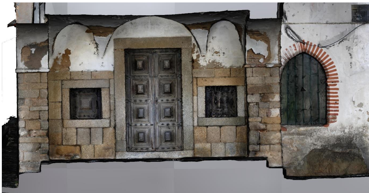
Fig. 4.1. Ortoimagem – corte vertical, visando o alçado interior do adro, em resultado da reconstrução e obtido através do CC
