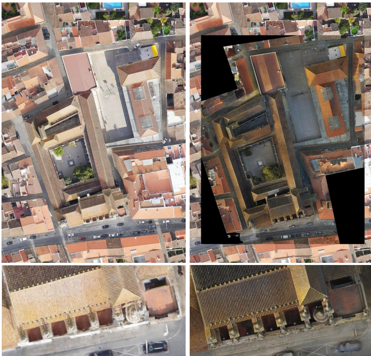
Fig. 5.5. Imagens do levantamento aerofotogramétrico; da sobreposição da imagem equivalente produzida a partir do modelo digital; e de pormenor comparativo entre ambas (programa QGIS)
