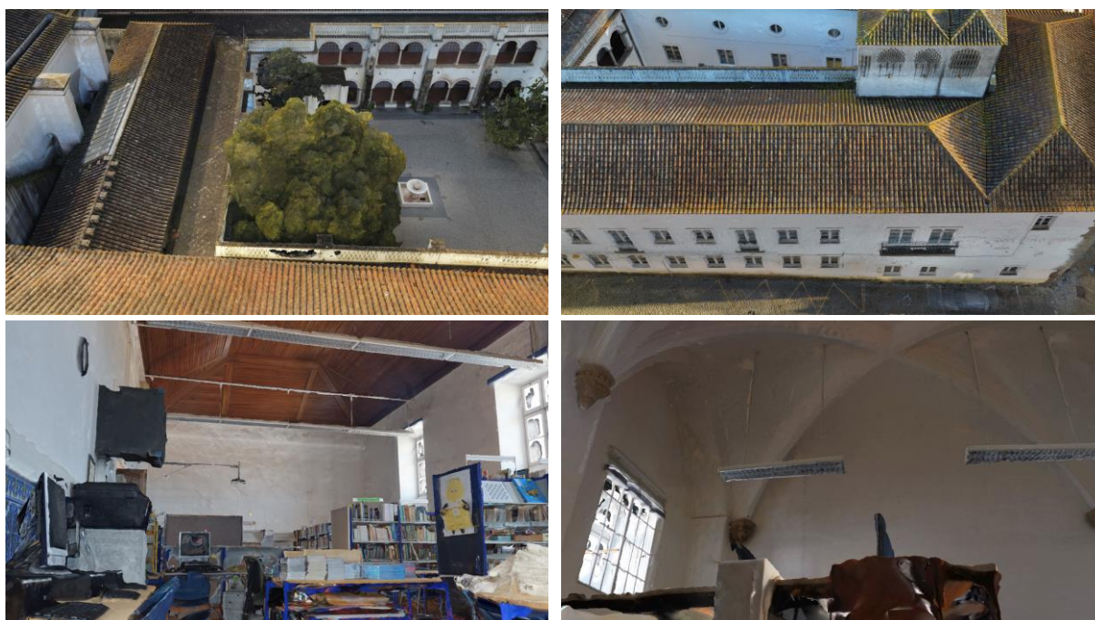
Fig. 5.1. Imagens de renderização do modelo de quarteirão, ilustrando lacunas e falhas de texturização, e do modelo com espaços interiores, ilustrando falhas de modelação (programa RC)
