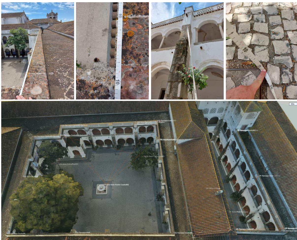
Fig. 5.4. Fotografias ilustrando as medições efetuadas no local, de tipo planimétrico e altimétrico; em baixo renderização do modelo do quarteirão, identificando os pontos similares de medição
