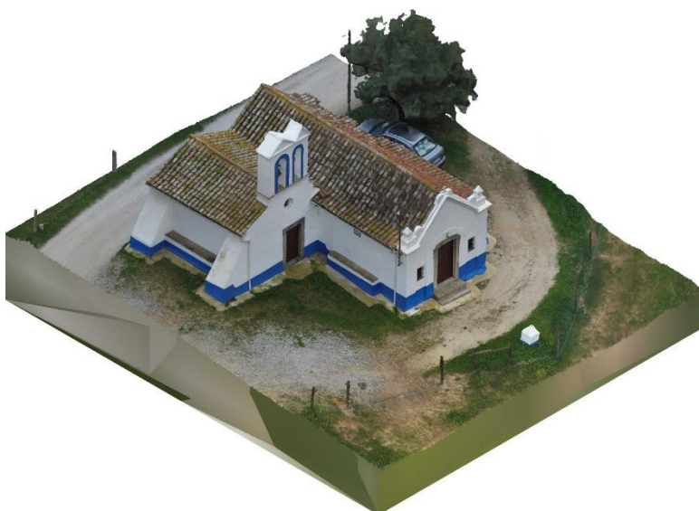
Fig. 4.2. O referencial de escala utilizado, na esquina da capela (Fotografia do autor); Fig. 4.3. Axonometria do modelo de superfície texturizado resultante da reconstrução e obtida do CC
