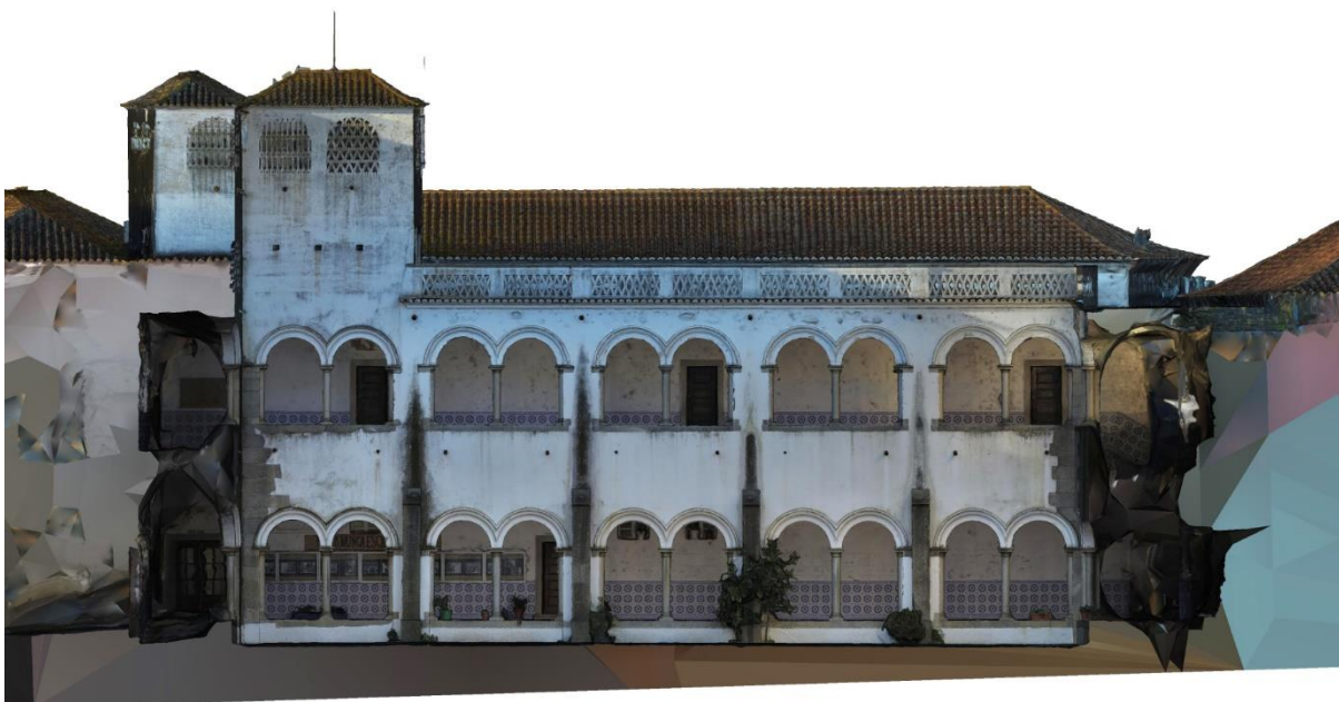
Fig. 4.5. Ortoimagem - primeiro corte vertical, visando interior a norte do claustro do poço, em resultado da reconstrução e obtido do CC
