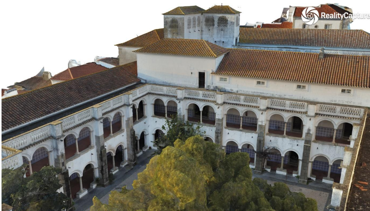
Fig. 4.9. Modelo de superfície texturizada, em visualização perspetivada, no RC.
