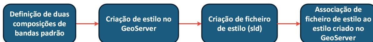
Figura 23 – Esquema representativo do fluxo de processos com vista à criação de estilos para as imagens do Sentinel-2.
