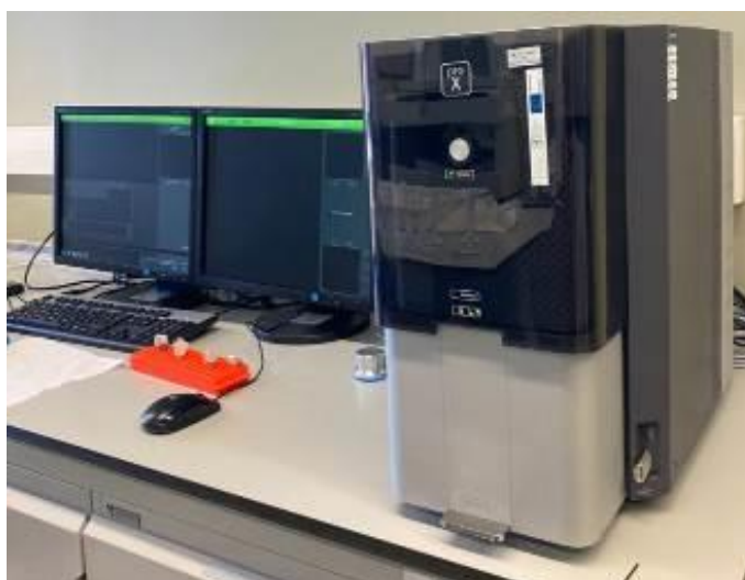
Figura 3.23 Microscópio eletrônico de varrimento de mesa Phenom Pro
