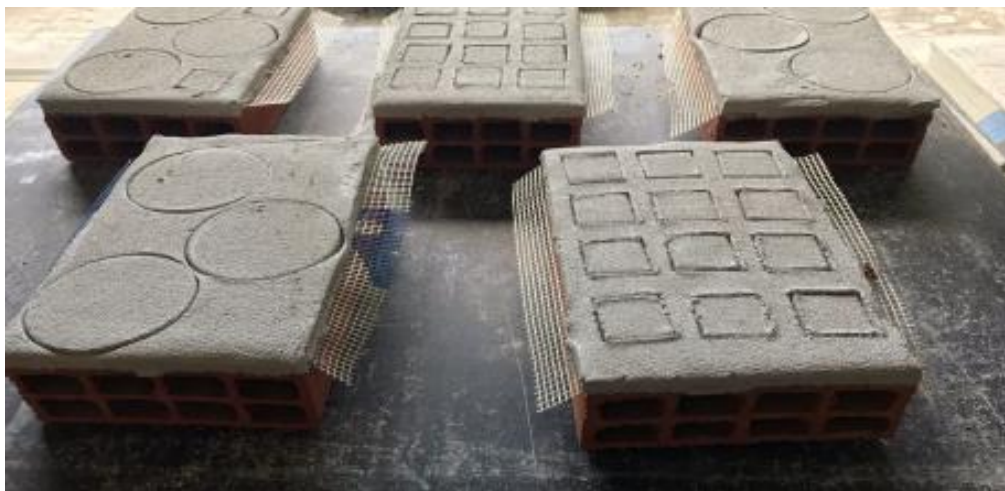
Figura 3.9 Provetes com as dimensões marcadas, quadrados (40 x 40 mm) e circulares (diâmetro de 10 cm)
