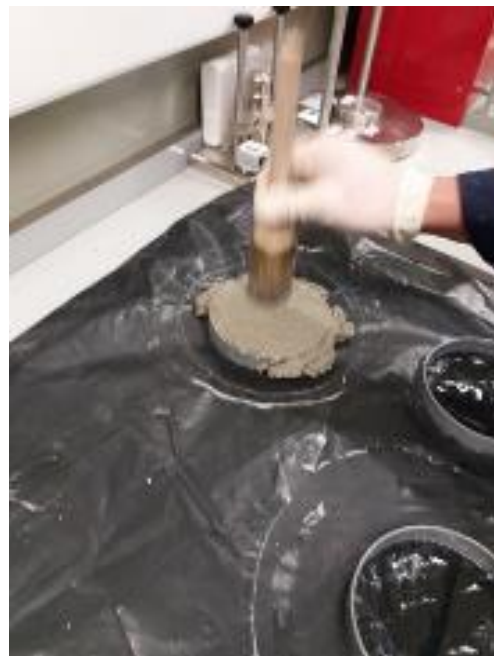
Figura 3.6 Provetes circulares - compactação manual
