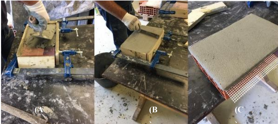
Figura 3.8 Aplicação da argamassa no substrato - (A) Aplicação da argamassa; (B) Acabamento da superfície; (C) Provete finalizado
