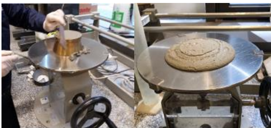
Figura 3.11 Ensaio de consistência por espalhamento
