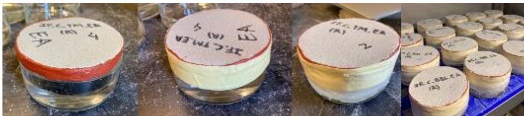
Figura 3.13 Ensaio de permeabilidade ao vapor de água
