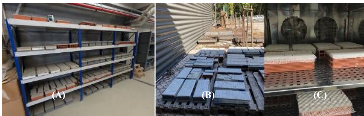
Figura 3.10 Condições de cura. (A) Local de armazenamento coberto, (B) Local de acondicionamento dos provetes no exterior. (C) Câmara para envelhecimento acelerado
