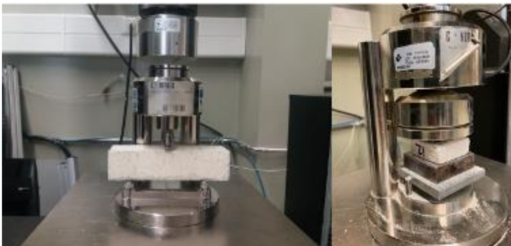
Figura 3.16 Ensaio de resistência a tração por flexão (esq.) e à compressão (dir.)
