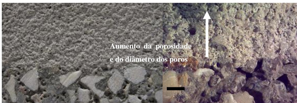
Figura 4.21 Argamassa aplicada ao bloco de betão – (dir.) Fotografia, (esq.) Lupa estereoscópica (barra: 1mm)
