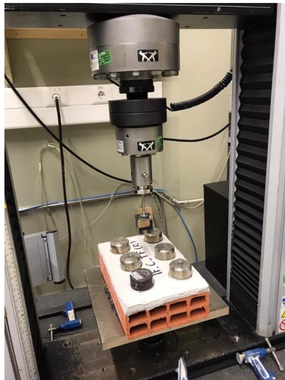
Figura 3.18 Ensaio de resistência adesiva
