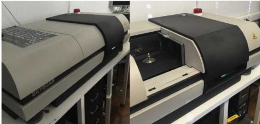
Figura 3.21 Ensaio de microtomografia de raios-X
