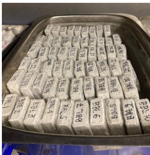
Figura 3.14 Ensaio de índice de secagem
