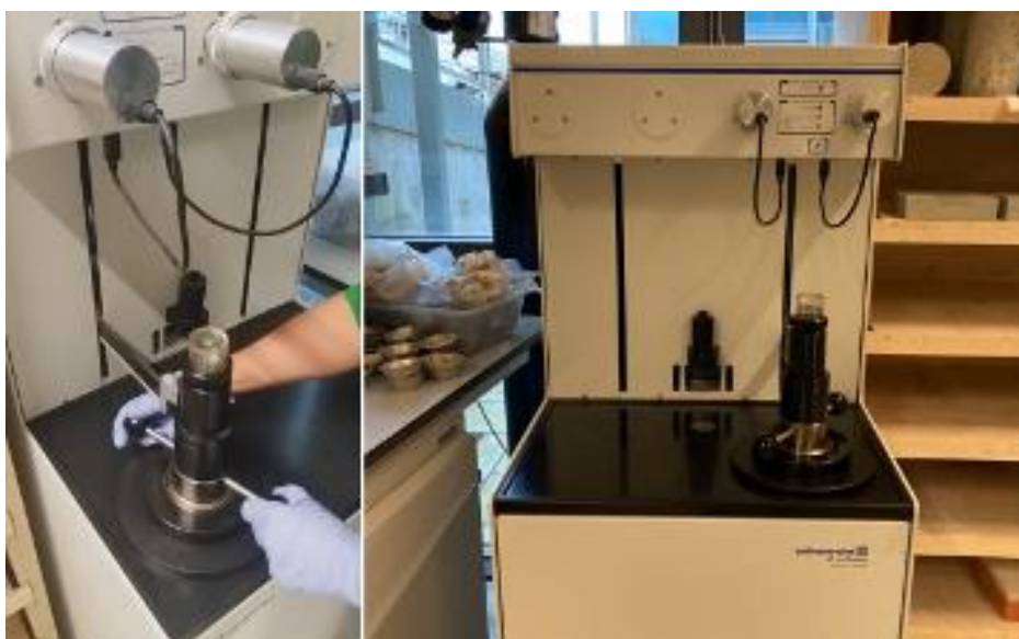
Figura 3.17 Ensaio de porosimetria
