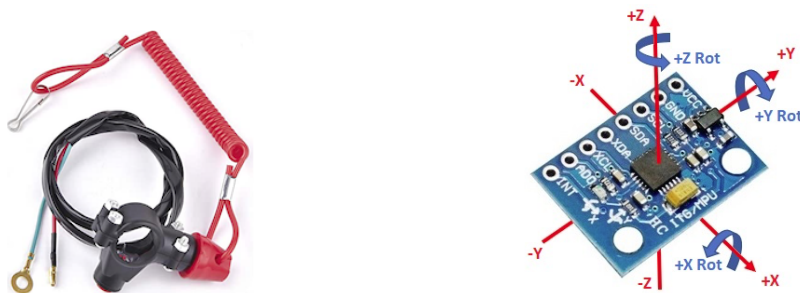
(a) Interruptor de emergência kill-switch [53] (b) Eixos do módulo GY-521 MPU-6050 [54]
