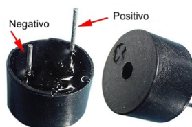
Figura 3.13: Piezo buzzer TMB12A05
