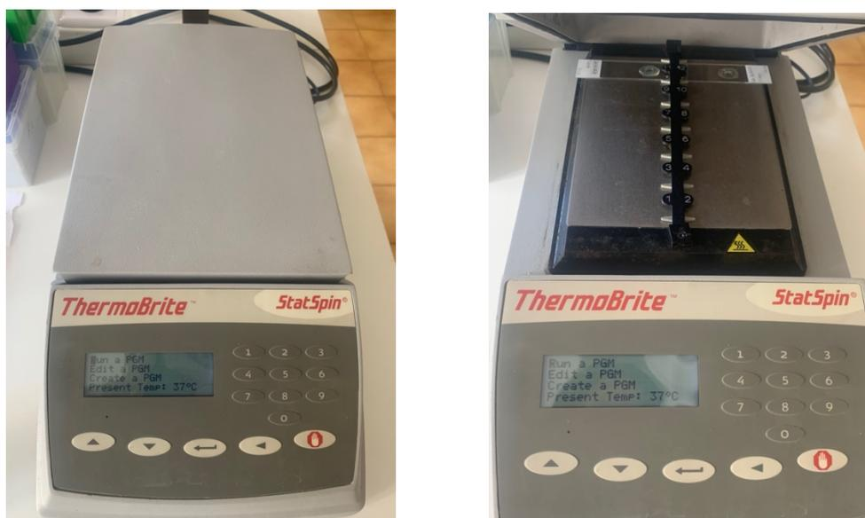
**Figura 20 | ThermoBrite.** Aparelho de desnaturação e hibridação utilizado na técnica FISH. Imagens captadas pelo autor.
