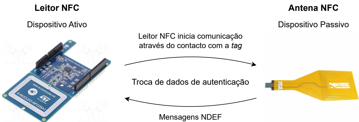
Figura 3.12: Comunicação NFC para troca de dados de autenticação entre dispositivos.
