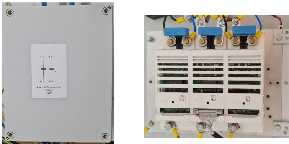
Figura C.3 – Banco de condensadores do barramento DC (esquerda) e ponte inversora trifásica (direita).
