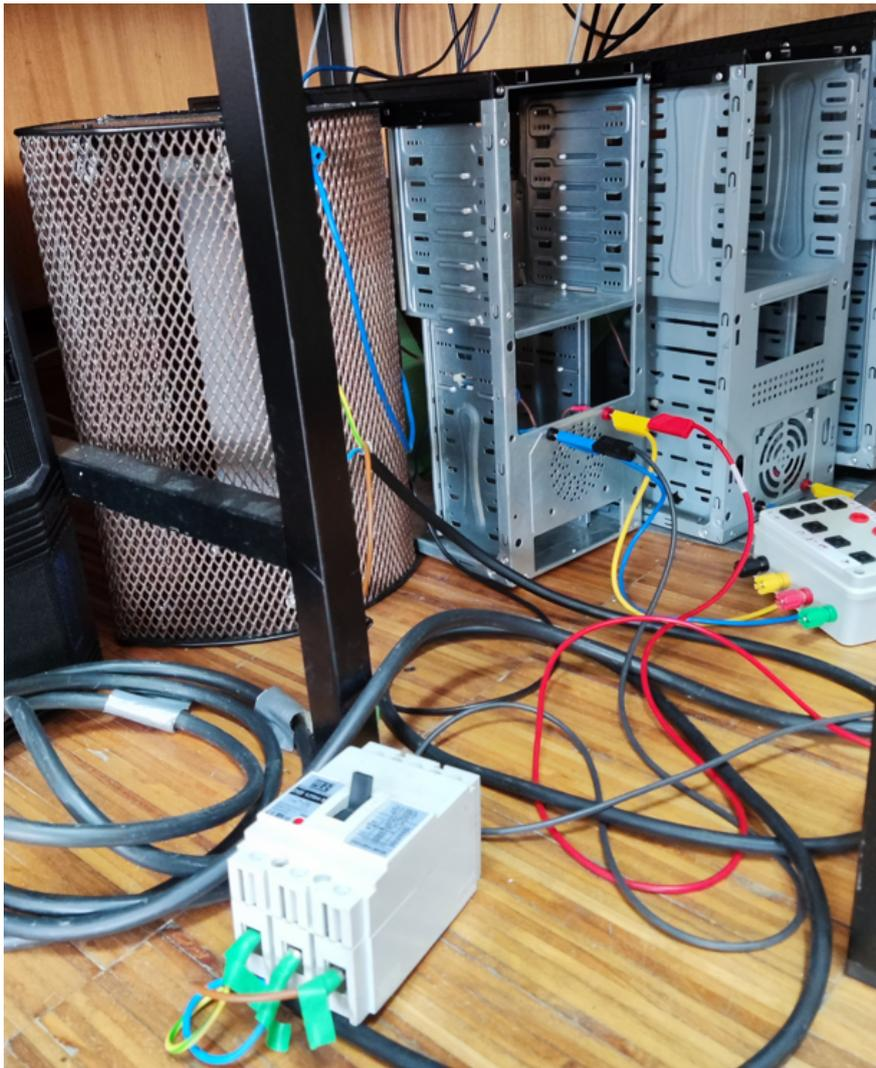
Figura A.3: Carga com duas resistências em paralelo e um *contactor* entre elas.
