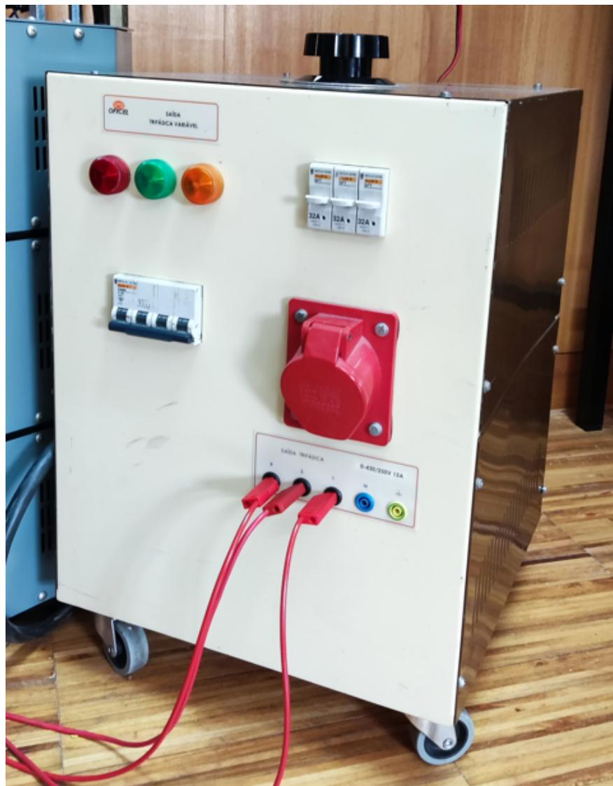
Figura A.1: Autotransformador.
