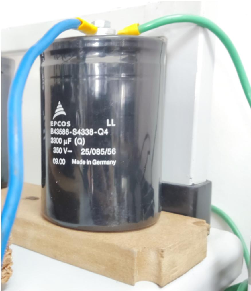
**Figura A.5:** Condensador do barramento DC.
