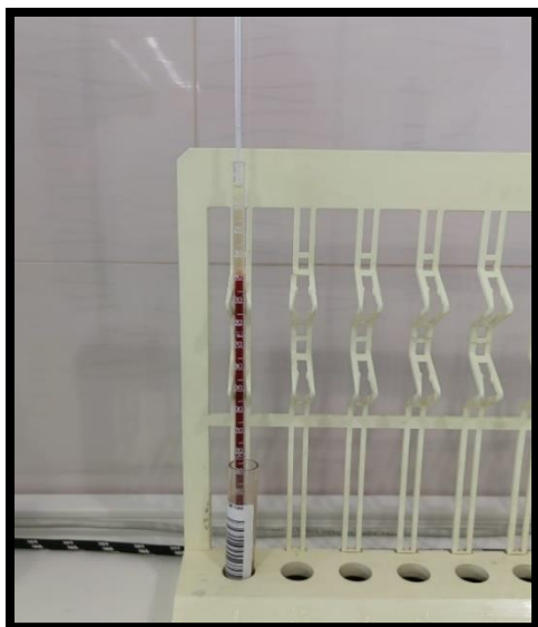
Figura 5 - Método Westergren para medição manual da velocidade de sedimentação.
