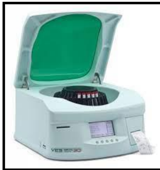
Figura 6 – Analisador de velocidade de hemossedimentação automático VES-MATIC 30.
