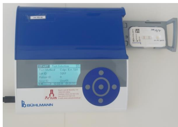
Figura 7: Medição de calprotectina fecal pelo aparelho automático após migrar num lateral flow assay (fotografado no LACUC).
