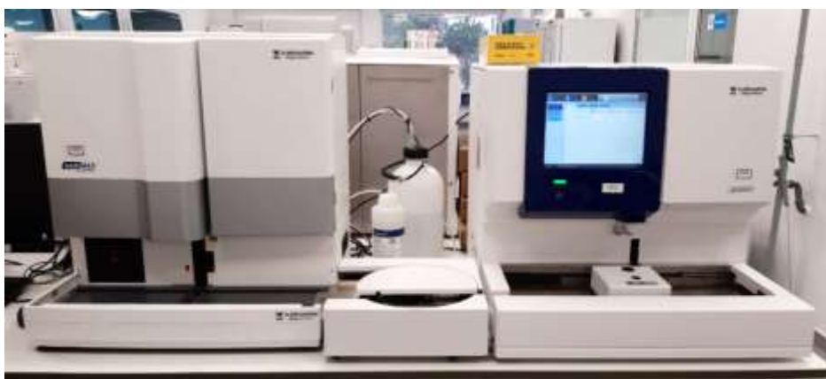
Figura 41 – Aparelhos UNAMAX e SEDIMAX da Menarini Diagnostics ® .
