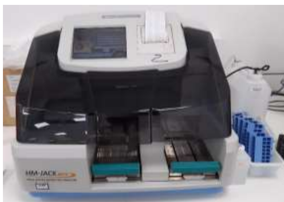
Figura 42 – Aparelho HM-JACKarc da Menarini Diagnostics ® utilizado na pesquisa de sangue oculto nas fezes.
