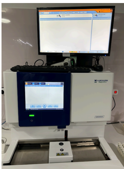
Figura 16. Aparelho Aution Max AX-4280, onde realiza-se a análise físico-química da urina.
