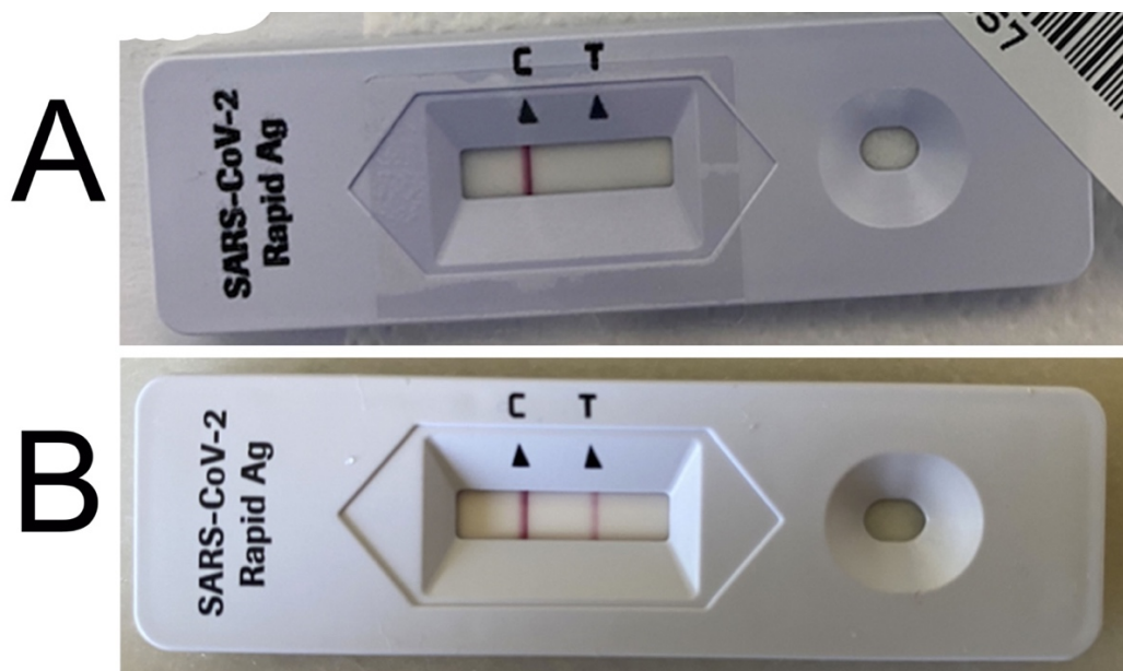
Figura 7. Cassete de teste rápido para SARS-CoV-2, onde C significa controlo e deve sempre surgir a linha vermelha, indicando a boa qualidade do teste. A região T quando o teste é negativo não apresenta linha vermelha, e quando o teste é positivo, apresenta a linha vermelha. A - Resultado negativo; B - Resultado positivo.
