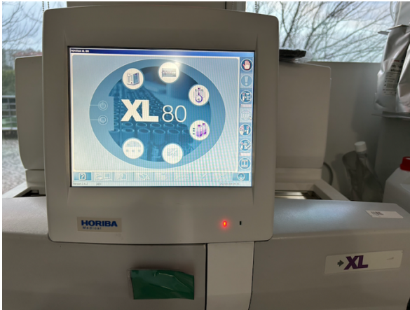
Figura 26. Horiba Pentra XL80, aparelho utilizado para realizar os hemogramas (série vermelha, série branca e plaquetas). Imagem ilustrativa da técnica, extraída do manual do equipamento (39).
