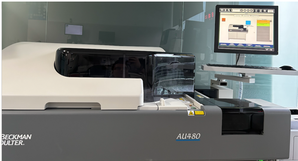
Figura 33. Aparelho Beckman-Coulter AU480, onde realiza-se a determinação diversos analitos como a Glicose, Ureia, Creatinina, Bilirrubinas, Ácido Úrico, Colesterol Total, HDL e LDL, Triglicéridos, Fosfatase alcalina, AST/TGO, ALT/TGP, GGT, Amilase, Lipase, LDH, CK, Proteínas totais e Albumina, entre outros.
