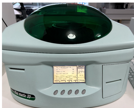
Figura 31. Ves-Matic 30, aparelho utilizado para velocidade de sedimentação.
