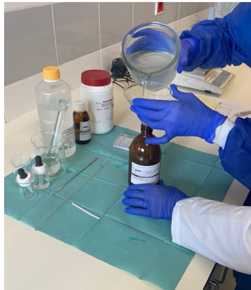
Figura I - Preparação de Metilcelulose a 1%
