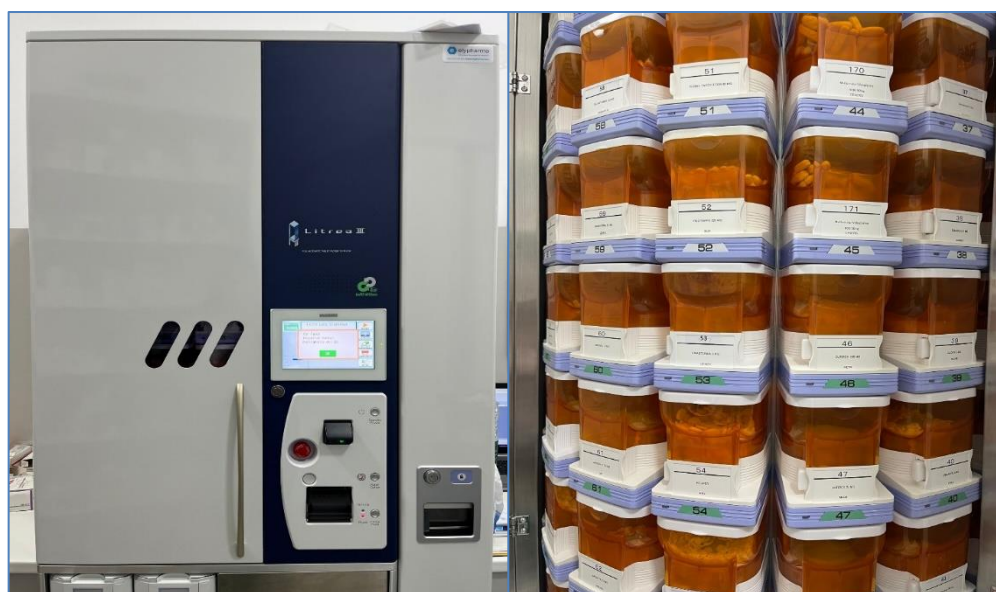
Figura 4 - Máquina de preparação da PIM e Canisters
