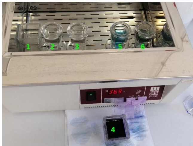
Figura 18- Procedimento de bandagem GTL: (1) Tratamento com tripsina; (2) Lavagem com solução de NaCl; (3) Lavagem com tampão Gurr ; (4) Coloração dos cromossomas com corante de Leishman ; (5) Lavagem com tampão Gurr ; (6) Lavagem com água destilada. Imagem cedida pelo LCG-FMUC.
