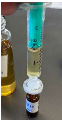
Figura 2.3 - Filtração de uma amostra de uísque através de uma membrana porosa 0.45 \mu m diretamente para o vial de HPLC
