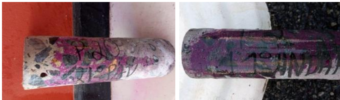
Figura 5.7 – Exemplos de aplicação da solução de fenolftaleína em carotes frescos. (Acervo técnico da Tecomat Engenharia)
