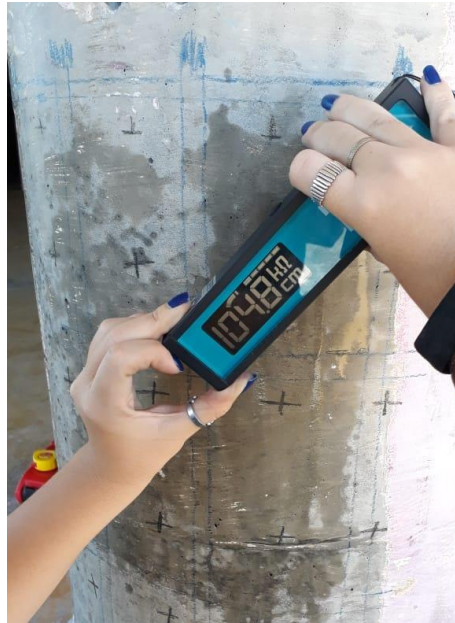
Figura 3.3 - Ensaio de Resistividade Elétrica em pilar. (Acervo pessoal)
