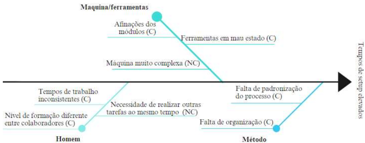
Figura 4.3. Diagrama de Ishikawa relativo às variáveis que afetam o tempo de setup.
