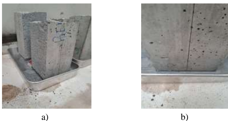
Figura 3.11 Ensaio de absorção por capilaridade: a) Vista geral; b) Vista em pormenor
