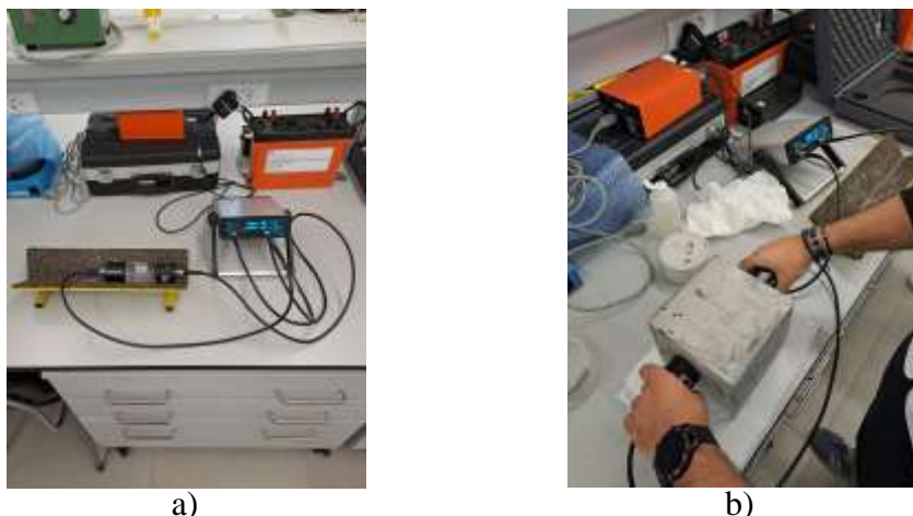
Figura 3.16 Ensaio de Ultrassons: a) calibração do equipamento; b) Medição do sinal
