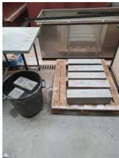
Figura 3.7 Provetes desmoldados a ganhar cura
