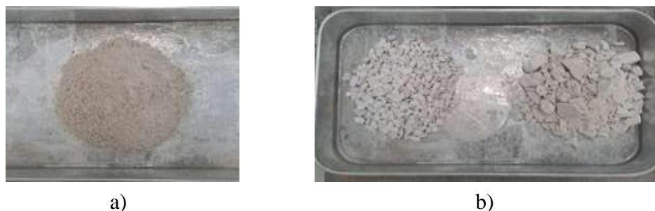
Figura 3.1 Fotografia dos agregados: a) Agregados finos, areia comercial; b) Agregados grossos: brita comercial e Tout Venant (resíduo em estudo)
