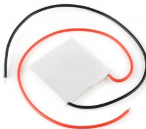
Figura 4.5: Aspeto habitual de uma Pastilha Peltier. Retirado de [67].
