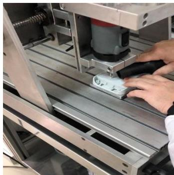
**Figura 3.11:** Maquinação de um sistema Wireless Plus
