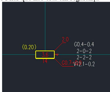
Figura 3.12-Exemplo de Pilar que não está em segurança
