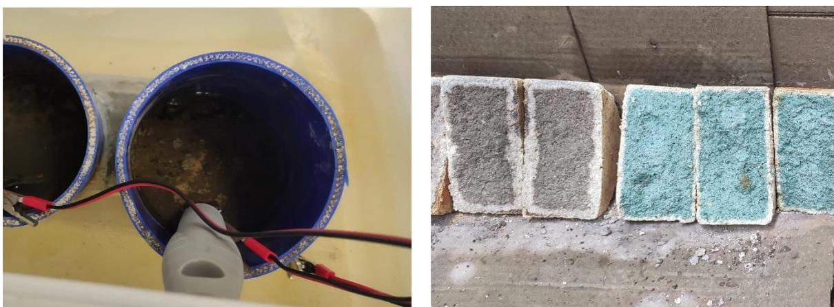
**Figura 4.12 – a) Possível reação da solução de hidróxido de sódio (NaOH) com as misturas de escórias e cal hidráulica; b) Inexistência da marca de penetração dos cloretos nos provetes das misturas com ligante de cal hidráulica (provetes à esquerda) e escórias (provetes à direita)**
