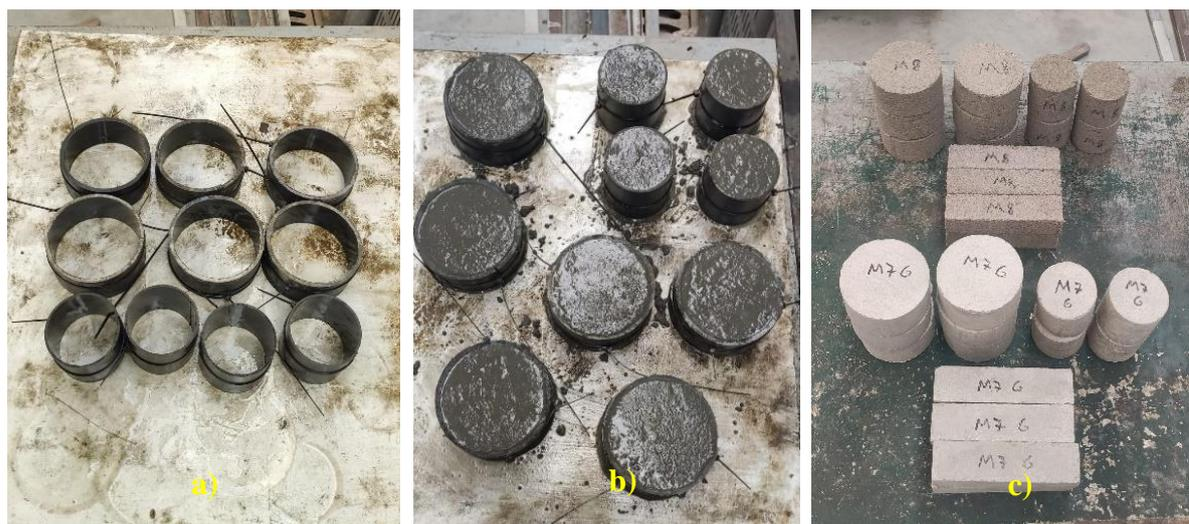
**Figura 3.6 - a) Moldes cilíndricos utilizados; b) Moldagem dos provetes cilíndricos; c) Aspeto final dos provetes após a sua desmoldagem**
