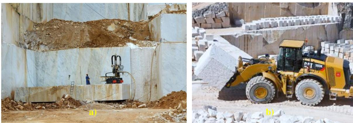
**Figura 2.1 – a) Procedimento do corte de pedra natural (Fonte: <https://outraspalavras.net/outrasmidias/o-sangue-extraido-das-pedreiras-do-espírito-santo/>); b) Transporte dos blocos de pedra (Fonte: <http://www.solancis.com/pt/pedreiras/extracao>)**
