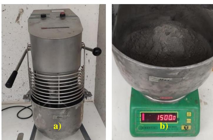
**Figura 3.3 - a) Misturadora utilizada; b) Pesagem do agregado e ligante(s) de cada uma das amassaduras**
