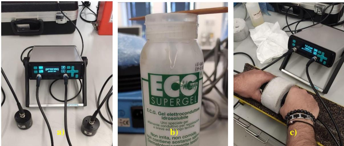
**Figura 3.14 - a) Aparelho utilizado no ensaio de velocidade de propagação de ondas ultrassônicas; b) Massa de contacto utilizada; c) realização do ensaio de velocidade de propagação de ondas ultrassônicas**
