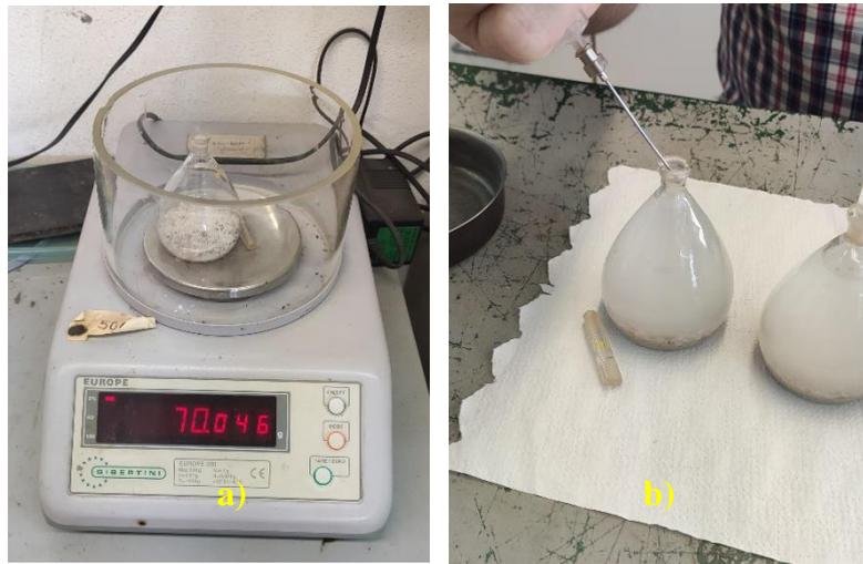
**Figura 3.9 - a) Pesagem do picnómetro com agregado; b) Enchimento do picnómetro com água até à superfície do mesmo**
