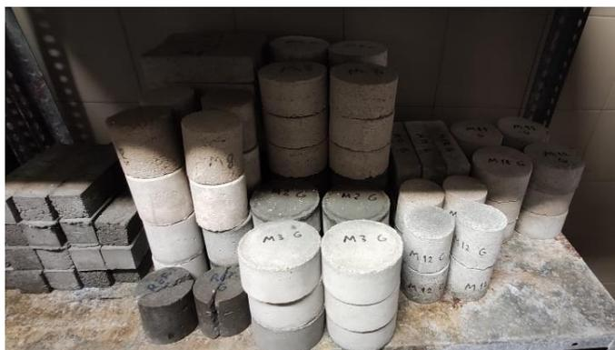
**Figura 3.7 - Introdução dos provetes na câmara húmida**
