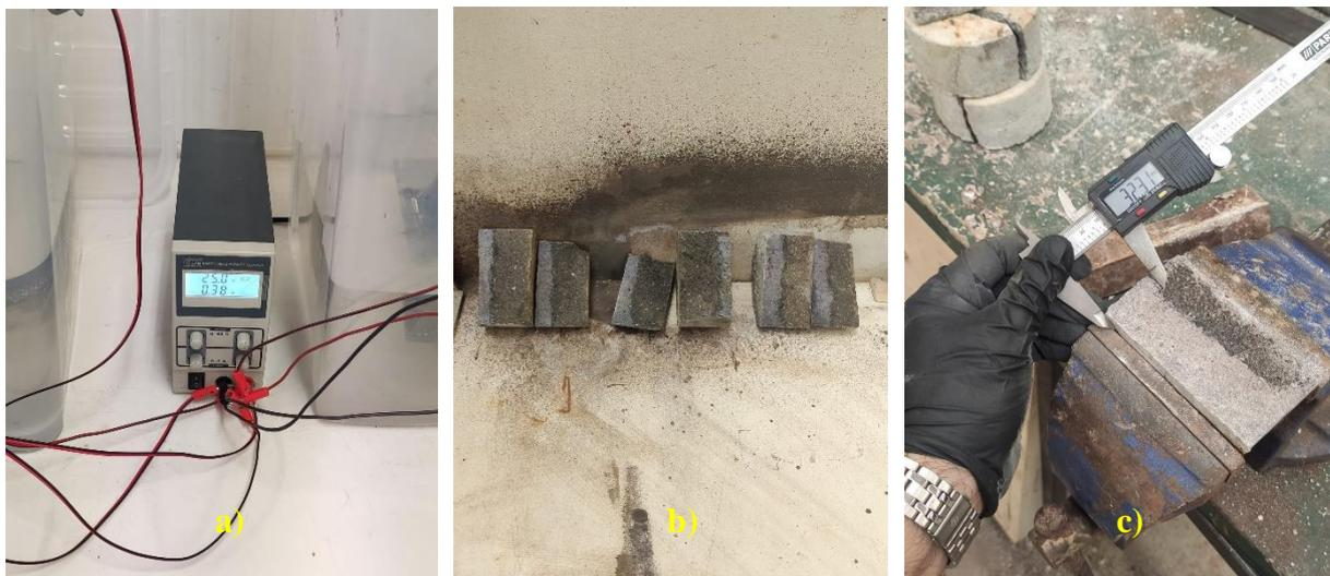
**Figura 3.16 – a) Fonte utilizada e os respectivos cabos que farão a ligação; b) Pulverização das metades dos provetes com a solução de nitrato de prata; c) Medição da penetração de cloretos através de um paquímetro digital**
