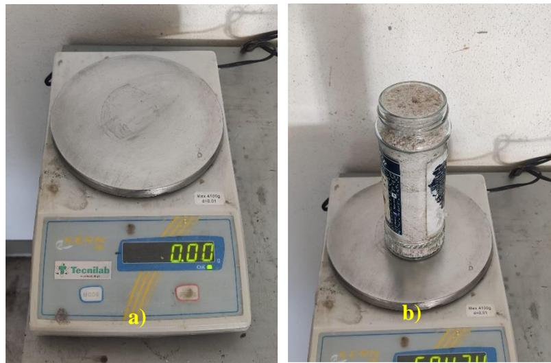
**Figura 3.10 – a) Balança utilizada; b) Pesagem do recipiente com o agregado devidamente nivelado**
