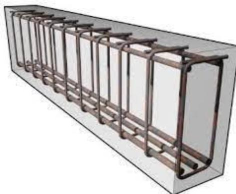
Figura 2.1 – Viga de betão armado tradicional ([www.carluc.com.br](http://www.carluc.com.br))
