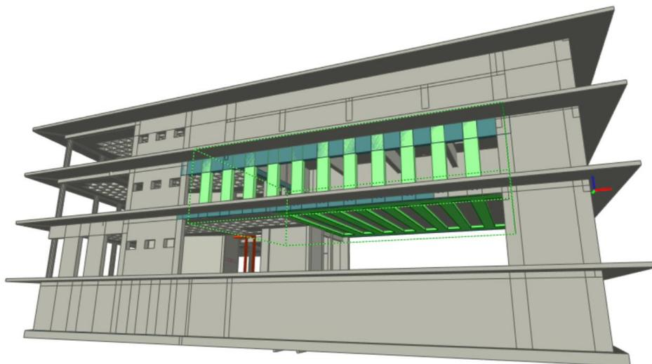
Figura 7.10 - Localização do pós-tensionamento no edifício
