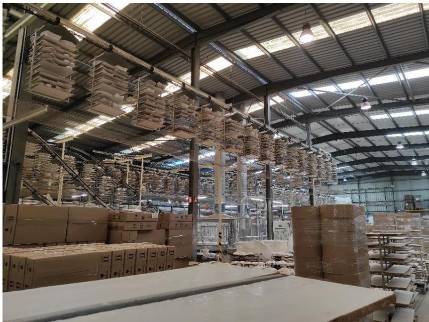
Figura 2.14- Transportador aéreo com secagem[41]
