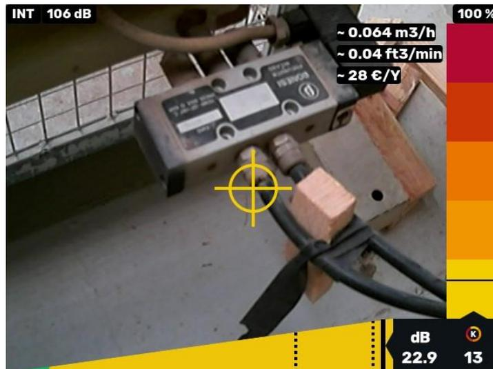
Figura 3.12- Fuga de ar comprimido[41]
