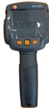
**Figura 3.4- Câmara Termográfica**
