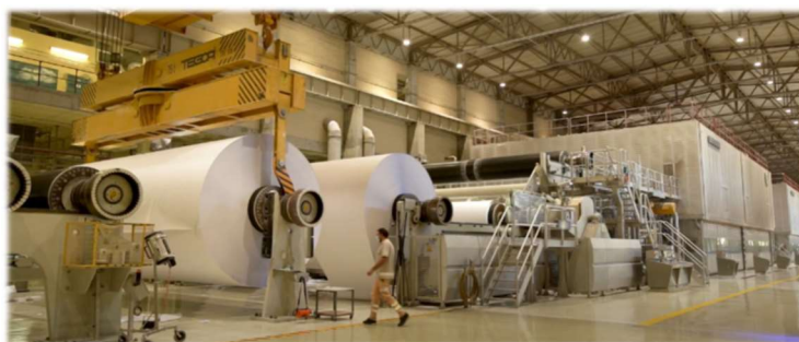
Figura 3.1. Máquina de papel e “jumbos”. Fonte: EDP Portugal (2022).
