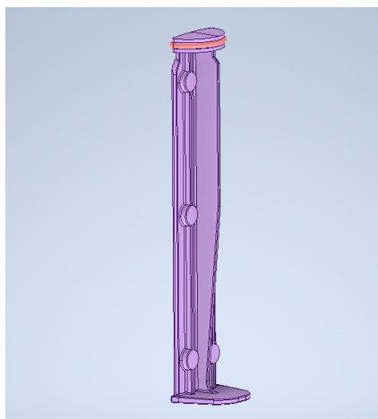
Figura 4.1: Êmbolo da Seringa DUO desenhado pelo Polo de Inovação em Engenharia de Polímeros (PIEP).
