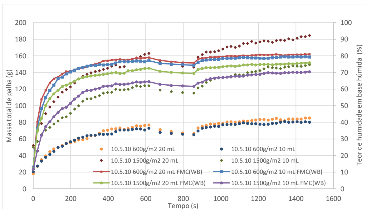
Figura 3.14 – Evolução da massa e do teor de humidade em base húmida dos ensaios P(10.5.10)
