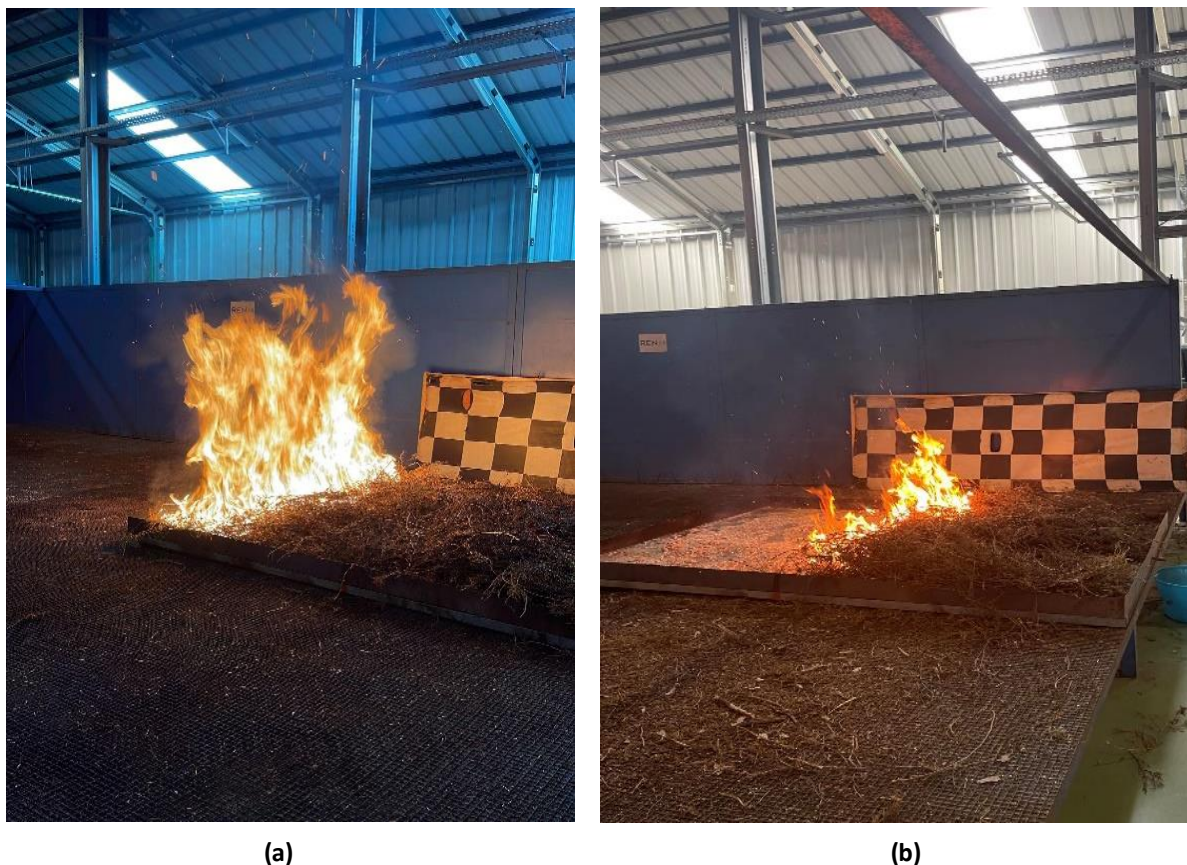
Figura 2.5 – Visualização da intensidade de frente de chama: antes do contacto com a área de humedificação (a) na área de humedificação (b)
