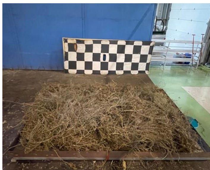
Figura 2.2 – Mesa de queima horizontal preparada para a realização do ensaio
