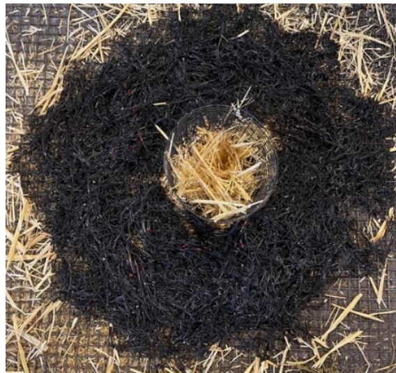
Figura 2.13 – Ensaio 4, sem que a palha tivesse sido consumida no interior do cilindro metálico
