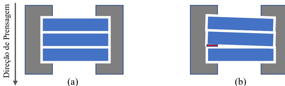
Figura 4.7. (a) Operação 150 sem a presença de limalha; (b) Operação 150 com presença de limalha
