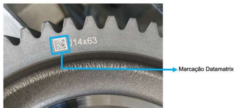
Figura 3.11. Marcação Datamatrix presente na coroa em peça negra
