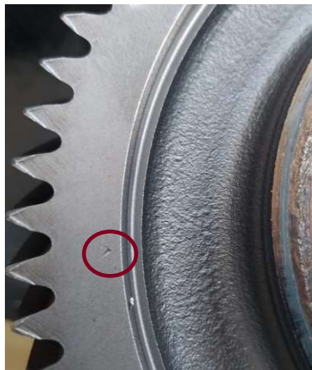
Figura 4.6. Caixa diferencial com marca de limalha na face
