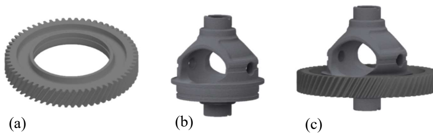
Figura 3.2. (a) Coroa; (b) Diferencial; Caixa diferencial Soldada
