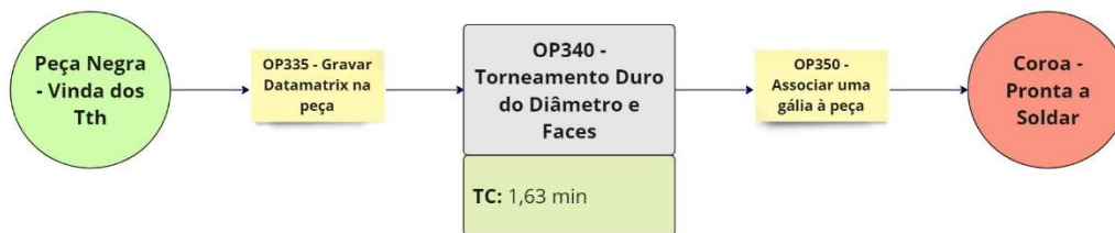
Figura 3.7. Fluxograma do processo de Torneamento Duro – Peça Negra
