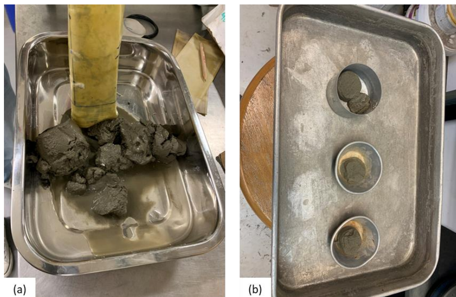
Figura 3-15 - Desmontagem das amostras após finalização do ensaio: (a) amostra ensaiada na FEUP; (b) amostra ensaiada em Coimbra.
