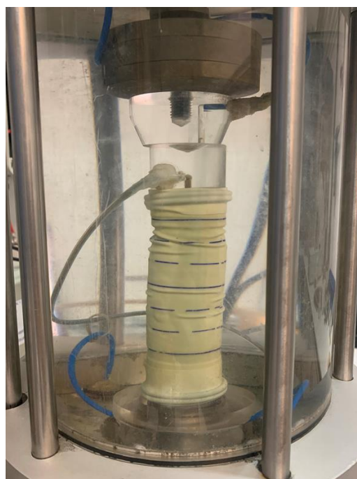
Figura 3-13 - Amostra do ensaio realizado na Universidade de Coimbra com o topo liquefeito e excentricidade de aplicação de carga.
