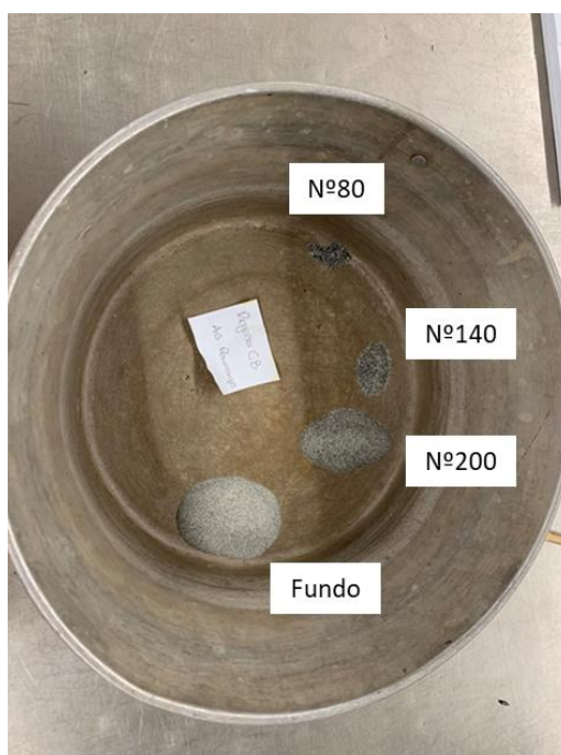
Figura 3-4 - Material separado no peneiramento.
