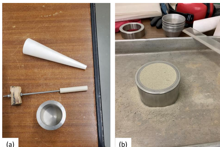
Figura 3-6 – (a) Material utilizado para ensaio do índice de vazios mínimo; (b) ensaio de índice de vazios mínimo.
