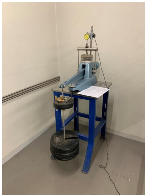
Figura 3-10 - Ensaio de adensamento em avanço.
