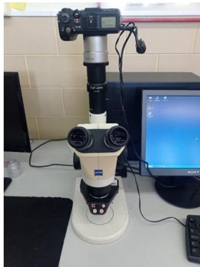
**Figura 3.7. Lupa Zeiss STEMI 2000C.**
