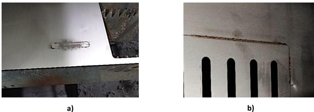
Figura 3.3. Não conformidade resultante da indevida seleção de parâmetros. Dificuldade em cortar (a) e má qualidade do corte (b).
