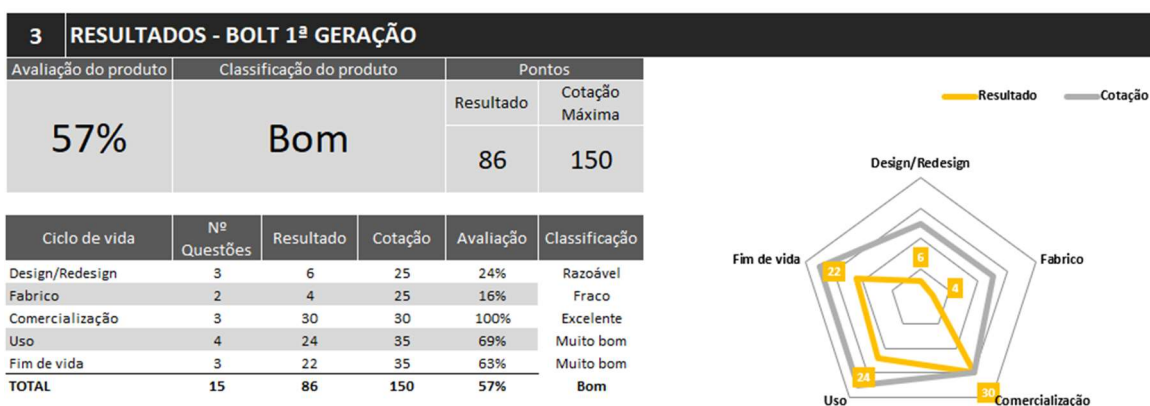
Figura 4.9 – Resultado do teste CEIP para a trotinete 1ª geração da Bolt (imagem retirada do teste).
