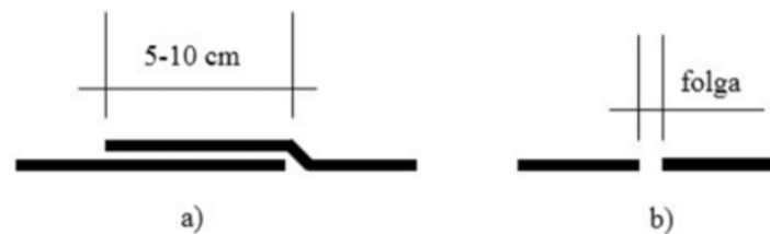
Figura 18. Emenda por transpasse (A) e justaposição lateral (B) - Thomé (2017)
