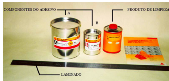
Figura 24. Componentes do sistema Pré-Fabricado – Juvandes (2009)
