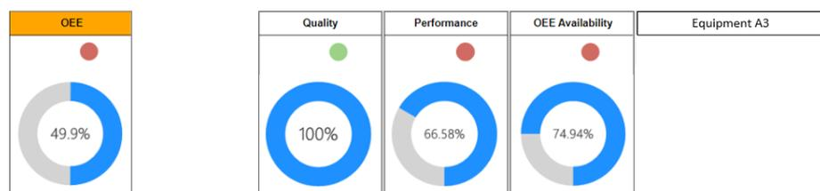
Figura 17 – Dashboard do OEE e dos seus componentes relativo ao equipamento A3 na semana 19.
