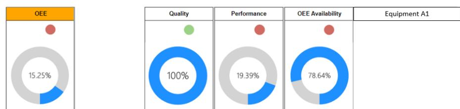
Figura 15 – Dashboard do OEE e dos seus componentes relativo ao equipamento A1 na semana 19.
