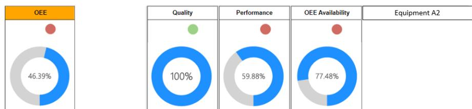
Figura 16 – Dashboard do OEE e dos seus componentes relativo ao equipamento A2 na semana 19.
