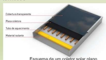
Esquema de um coletor solar plano
