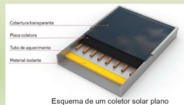
Esquema de um coletor solar plano
