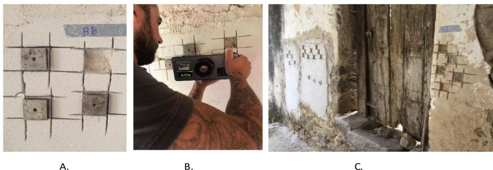
Figura 3.25 - a) Pastilhas coladas ao suporte, b) Ensaio de arrancamento c) Final do ensaio – arranque das argamassas
