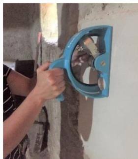
Figura 3.33 - Ensaio da resistência superficial - Esclerómetro Pendular
