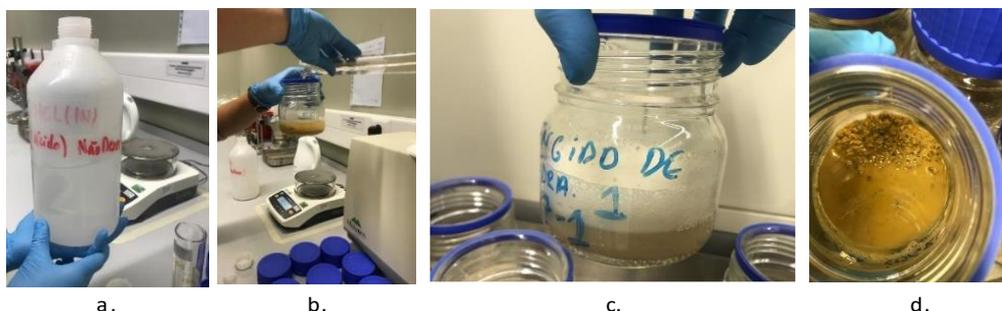
Figura 3.6 - a) Ácido clorídrico; b) Dissolução Ácida  $H_2O:HCl$ ; / Material Desagregado; c) Agitação e efervescência (reação química); d) Material dissolvido.
