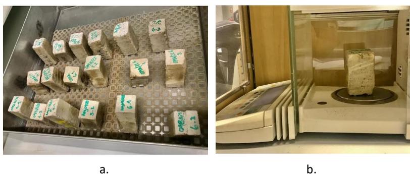
Figura 3.17 - a) Ensaio de Absorção de água por capilaridade; b) Pesagem em balança de precisão
