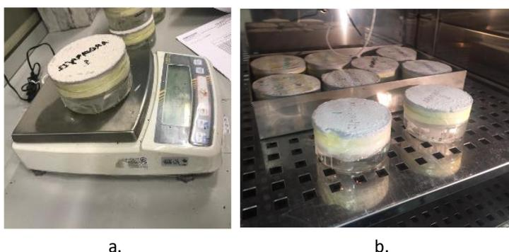
Figura 3.19 - Ensaio de permeabilidade ao vapor de água.
