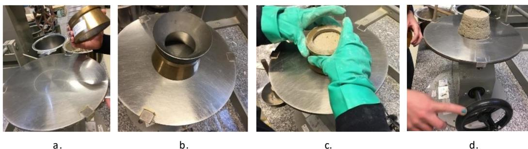
Figura 3.15 - a) Disco de espalhamento limpo; b) Molde cônico centrado; c) Retirada da argamassa do molde; d) Manivela cujo giro eleva a mesa e reproduz as pancadas que simulam a “queda” da argamassa.
