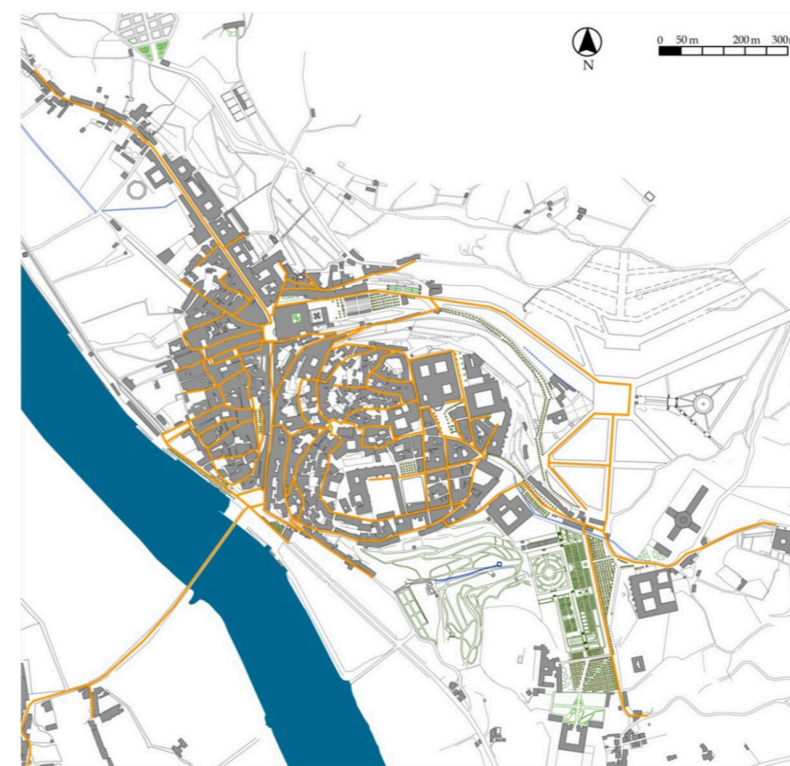
Imagem 52: Planta de reconstituição da rede de iluminação a gás em 1893 (421 candeeiros) de acordo com “Nota de 421 candeeiros d’illuminação publica da cidade existentes no dia 25 de novembro de 1893”[ Iluminação da Gás (Coimbra: AHMC/15/6)], Calmeiro (2015) p. 281.
