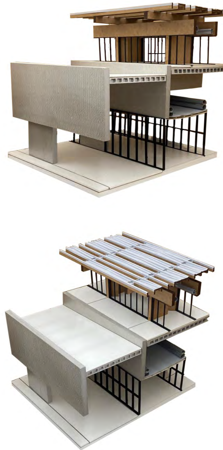
Figura 56 - Maqueta construtiva da Estação Ferroviária, escala 1:20
