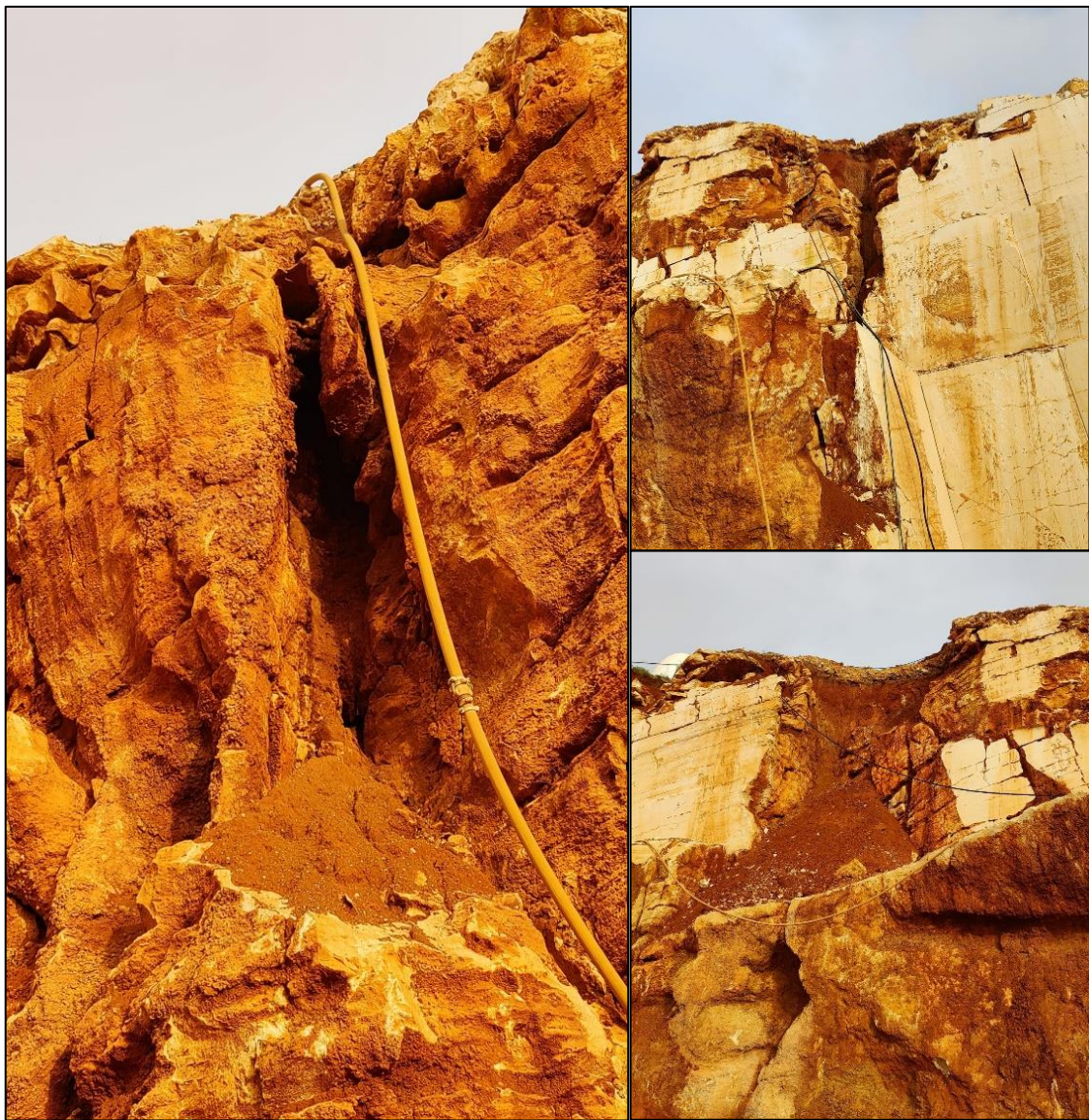
Figura 8 - Algares preenchidos por terra rossa no talude em estudo na pedreira Moleanos N.º 3.
