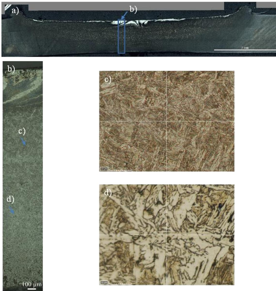
**Figura B.8:** a) Macrografia da soldadura  $S_{3_5}$  b) Secção vertical para microdureza. c) Microestrutura da 1ª interface. d) Microestrutura da 2ª interface.
