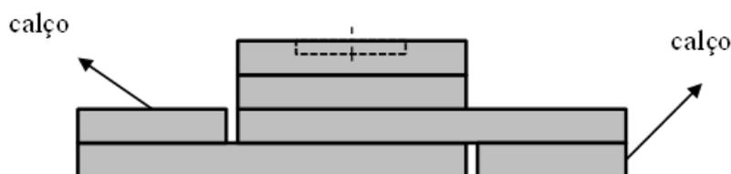
**Figura 3.6:** Esquema final das amostras para os ensaios de tração.
