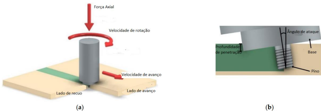
Figura 2-2 - Ilustração (a) geral do processo FSW e (b) detalhes da penetração da ferramenta e seus parâmetros (adaptado de [12]).
