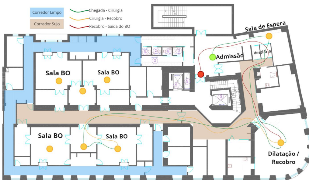
Figura 22 Diagrama de Esparguete para um doente com catarata no dia da cirurgia
