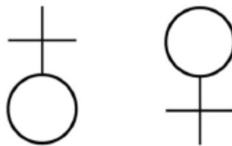
Tronelas cruzetadas (orientadas na planta com a posição de tiro representada pelo círculo)
